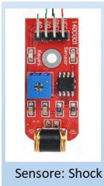
Figura 2 –il sensore 801S. Da sinistra a destra sono visibili i 4 pin per il collegamento con l'esterno: AO, DO, GND, VCC
