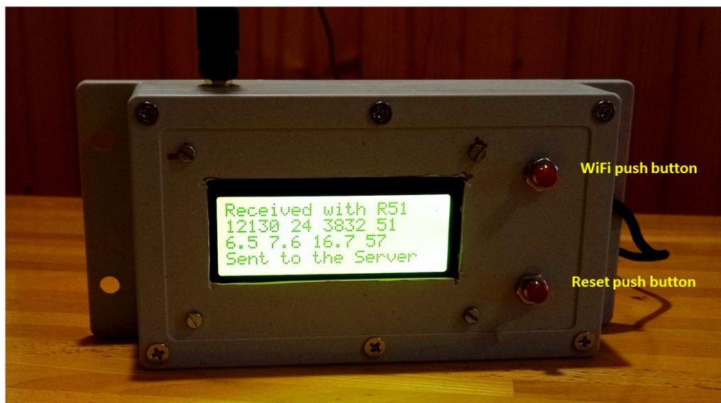
Figura 15 – Nodo ricevitore del sistema monitoraggio frane
