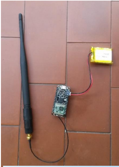
Antenna a stilo pieghevole collegata ad una scheda Adafruit Feather LoRa con batteria LiPo.
