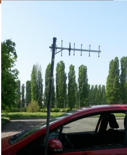
Se si vogliono ottenere portate maggiori si possono usare antenne direzionali come la Yagi, sempre però dimensionate per la frequenza 868 MHz. Nella foto, quella usata dall'autore per le prove di portata.
