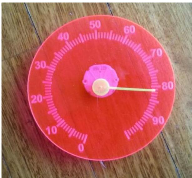
*Installazione del motore su un quadrante in metacrilato fluo, tagliato al laser e con la scala graduata incisa dallo stesso laser. Il disegno del quadrante è stato realizzato con Inkscape*
