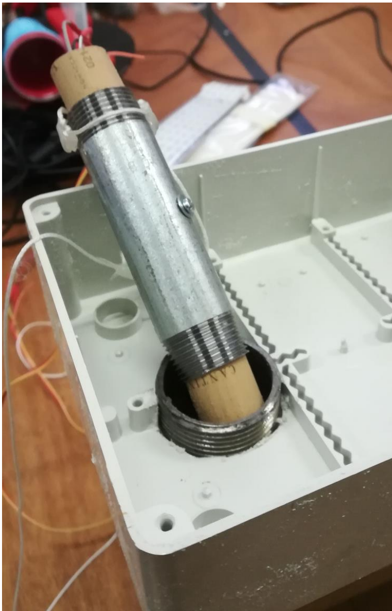
Particolare del tubetto contenente il sensore. La scheda sensore è fissata al tubetto con una vite bullone M3
